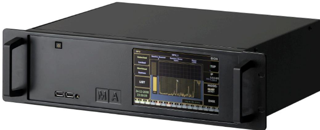
Die MA NPU (Network Processing Unit) bündelt die Rechenleistung im Netzwerk und bietet dieselbe Performance wie die grandMA2 Pulte. Sie bietet und verarbeitet 4.096 Parameter.
