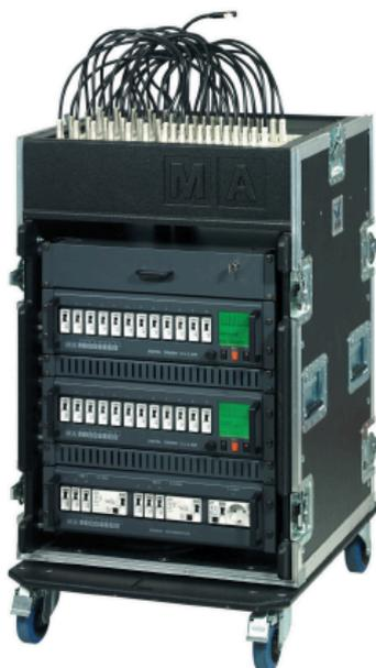
Die besonders robusten MA Digital Dimmer Racks im Amptown ABS-Case sind wahlweise mit zwei, drei oder vier MA Digital Dimmer Einschüben unterschiedlicher Leistung bestückt. Sie haben eine integrierte Unterverteilung (CEE oder Powerlock) mit allen vorgeschriebenen Fehlerstrom- (RCDs) und Leitungsschutzschaltern.
