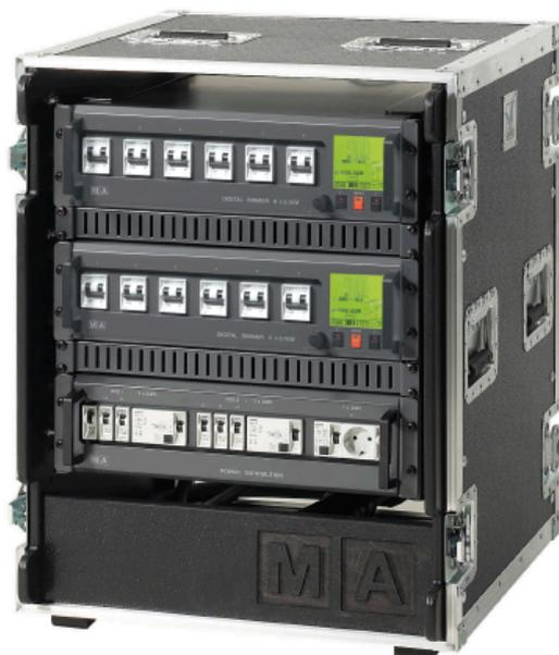
Die besonders robusten MA Digital Dimmer Racks im Amptown ABS-Case sind wahlweise mit zwei, drei oder vier MA Digital Dimmer Einschüben unterschiedlicher Leistung bestückt. Sie haben eine integrierte Unterverteilung (CEE oder Powerlock) mit allen vorgeschriebenen Fehlerstrom- (RCDs) und Leitungsschutzschaltern.
